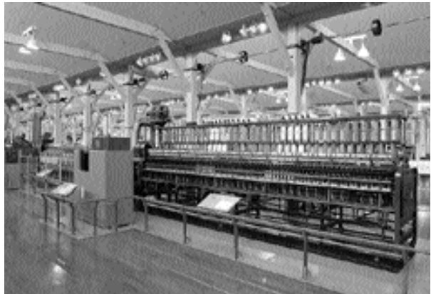
Máy kéo sợi ống hiện đại, phát minh của Platt, Anh Quốc, 1896
